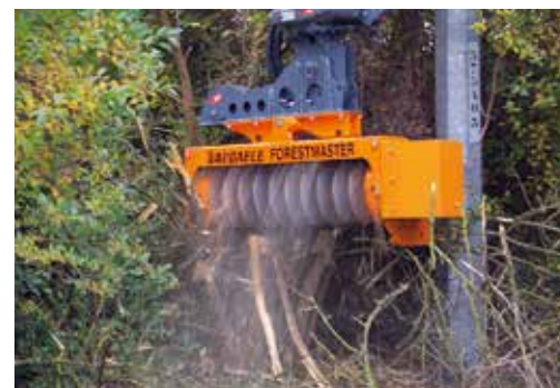
Tête de coupe avec rotateur cage pour tailler jusqu'à 10cm de diamètre.
