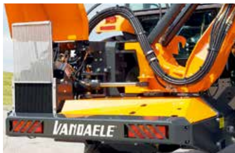
Centrale hydraulique carrossée, capot s'ouvrant dans le gabarit, grille pré filtre.
