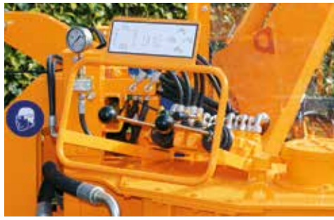
Munie en standard de leviers en croix, placés latéralement pour garder une bonne visibilité.
