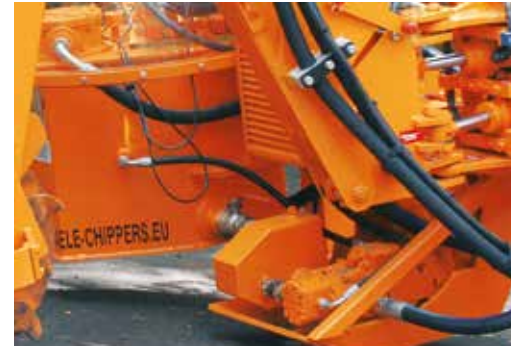
Circuit hydraulique intégré: double pompe, réservoir d'huile, refroidisseur d'huile.
