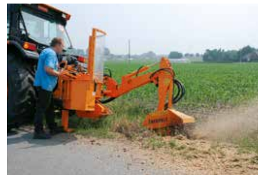
Visibilité optimale sur la zone de travail – le poste opérateur est protégé derrière un écran en plexiglas.
