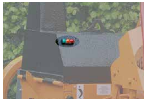
Système antistress "Classic": en standard sur les machines avec moteur – en option pour les versions tracteur.
