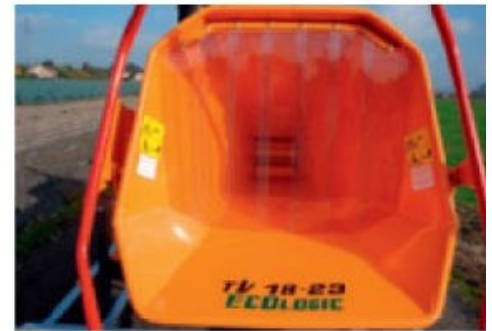
Rideau en plastique dans la trémie empêchant toute projection - en standard sur les versions EcoLogic (entraînées par moteur).
