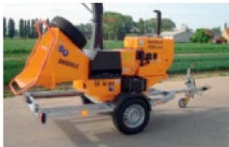
TV18-23D EcoLogic; Entraînement par moteur sur châssis pour transport rapide.
