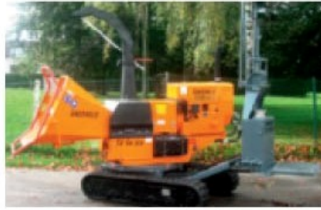
Version TV18-23 DTC ; machine autonome avec avancement hydraulique sur chenilles
