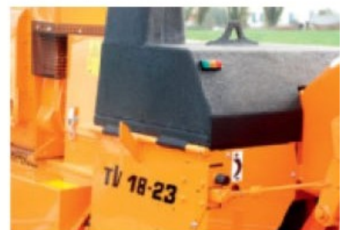
En standard sur version EcoLogic (avec moteur): coating antibruit sur le capot supérieur; sur l'accouplement et sur la trémie.
