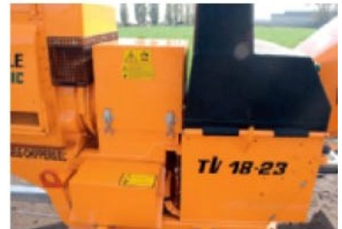
Version avec moteur : construction « en ligne » avec entraînement direct – sans courroie ni chaîne.
