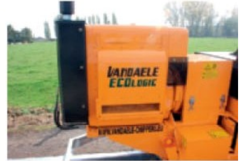
Moteur HATZ diesel 52 CV avec "Silent Pack" en standard sur les versions EcoLogic entraînées par moteur.
