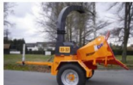
Machine sur châssis pour transport lent 40 km/h
