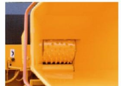
TV22-32 P; SUPER-GRIP grâce au rouleau supérieur à picots (équipement standard).
