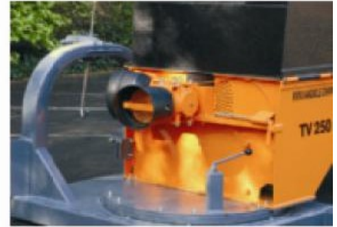
TV250 P; Machine sur 3 points, orientable 2 x 90° (option)
