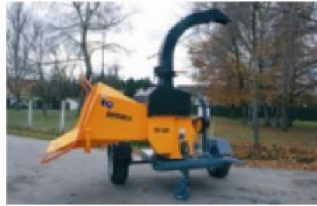
TV250 P; Version entraînée par tracteur sur châssis transport lent, orientable 2 x 90° (option).
