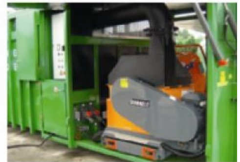
TV250 P; Construction sur mesure: moteur électrique, intégré dans un container:
