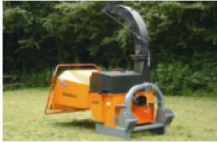
Machine standard – entraînée par la prise de force d'un tracteur
