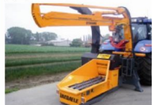
Trémie pour alimentation par grue montée sur un châssis intermédiaire.
