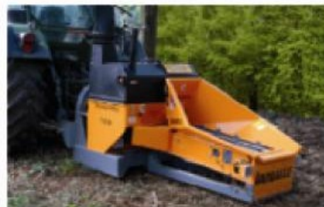
Trémie prévue pour être alimentée par une grue forestière – avec fond mouvant par chaînes (option).
