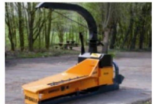
Trémie pour alimentation par grue avec trémie allongée et munie de chaîne d'alimentation (option).
