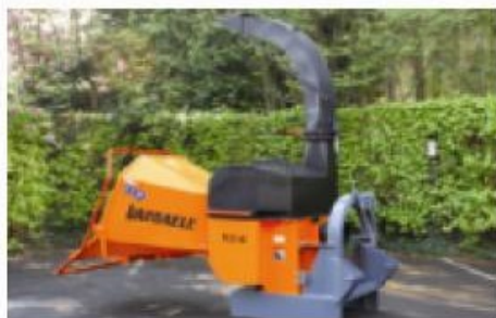
Machine standard – entraînée par la prise de force d'un tracteur
