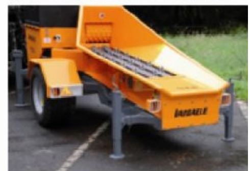
Trémie pour alimentation par grue avec trémie allongée sur remorque transport lent (option).
