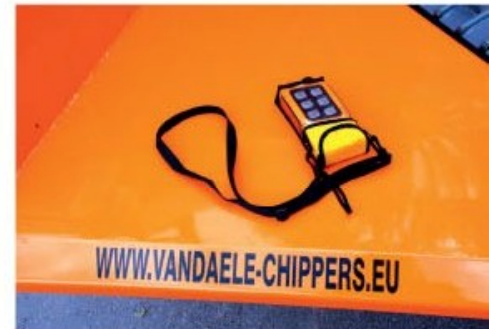
Toutes les fonctions sont électro-hydrauliques, contrôlées par une commande à distance.
