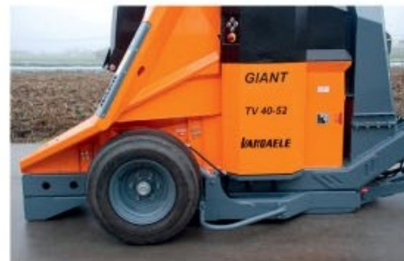
Option : châssis pour transport lent avec roues et timon à relevage hydraulique.
